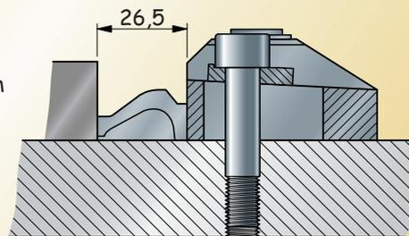
Fissaggio degli elementi con 2 viti rettifiche  $\varnothing$  10.2 - M 10.
